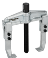
2-armet universalavdrager med induksjonsherdet spindel i galvanisert utførelse 60-200 mm 150 mm 4532-D
